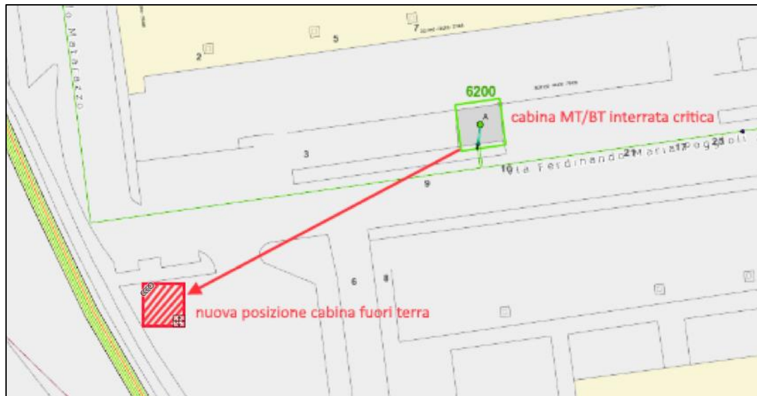
figura 3 - Esempio delocalizzazione cabina interrata
