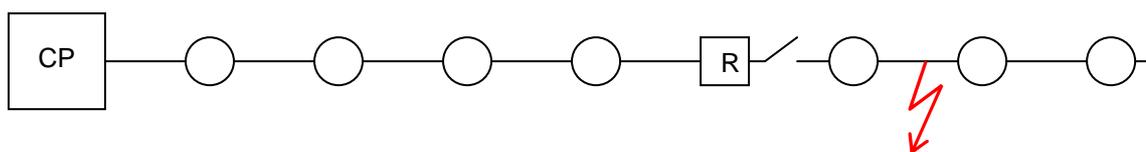
Il recloser, così come le protezioni delle linee MT, è dotato di un dispositivo di richiusura automatica per cui a seguito dell'apertura causata da un guasto verrà eseguita una richiusura rapida e, se questa non va a buon fine, una successiva richiusura breve. Nel caso in cui neanche la richiusura breve va a buon fine, il recloser scatta in maniera definitiva.
